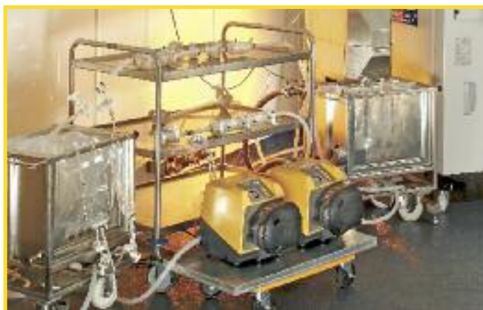
Riempimento sterile a flusso elevato di contenitori di prodotti monouso
