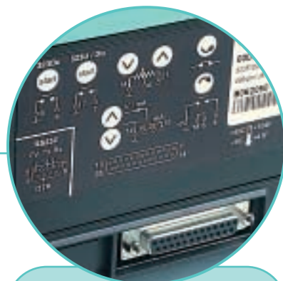
Sceita di opzioni di controllo: manuale, automatico analogico, automatico digitale con RS232
